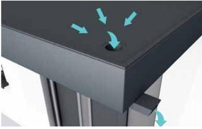
1. Dachdurchführung mit Wasserspeicher
